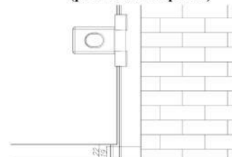
Установка с зазором 22 мм (российский вариант)
